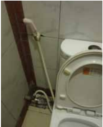
ムスリムの方も使えるトイレ。紙を使用しないので、ホースがついている。
